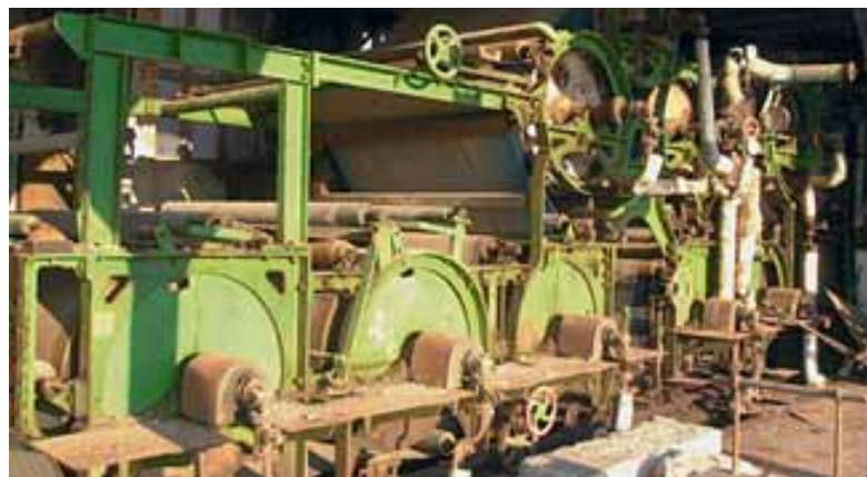
Kernstück der alten Fabrik ist die Papiermaschine.
