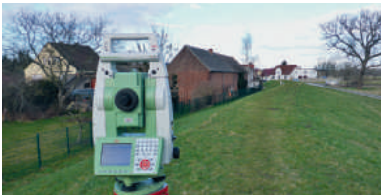
Ein Tachymeter steht auf dem Rosenburger Damm bei Barby.
